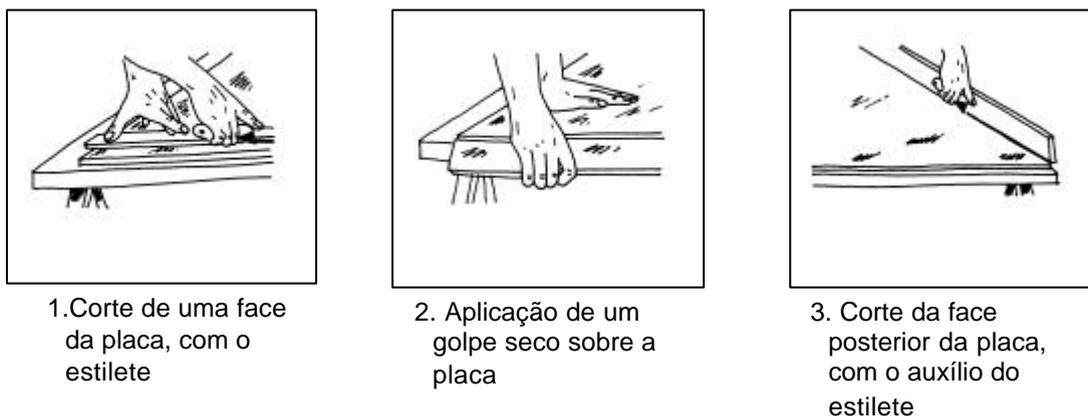
**FIGURA 5.3:** Procedimento para o corte das placas de gesso
